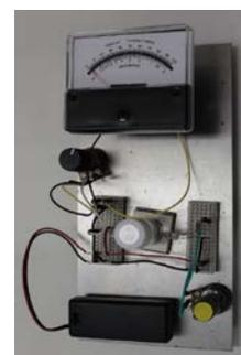
ブレッドボード型光度計組立キットを用いて光度計を制作します。自作した光度計で試料を測定し、試料溶液中に含まれる物質の濃度を求める光分析技術の理解を目指します。光度計の原理と機器に使用される部品について光度計を組立ながら学習をし、出来あがった光度計の各部品の配置により1) 比色法、2) 蛍光光度法、3) 濁度法の三つの測定が可能なることを学びます。最後に標準溶液を使った測定の結果から、透過率、吸光度と溶液に含まれる物質の濃度の関係を理解、濃度を求めるための検量線を作ります。なお受講者の経験、要望に応じて内容については柔軟に対応いたします。
